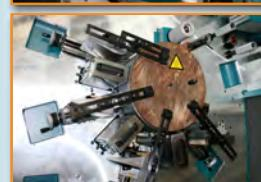
Cilindro d'impressione gravé, chromé et thermo réglé avec n.4 postes d'impression avec double régulation facile par un seul système de réglage
