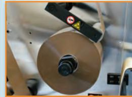
Portarolo di partenza da 3" con freno meccanico regolabile, pressore e sensore di fine bobina
