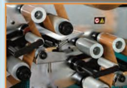
Stazioni di laccaura Primer e Release con rulli pressori in alluminio zigrinato, per mantenere il nastro adesivo il contatto con la soluzione chimica anche a velocità elevata
